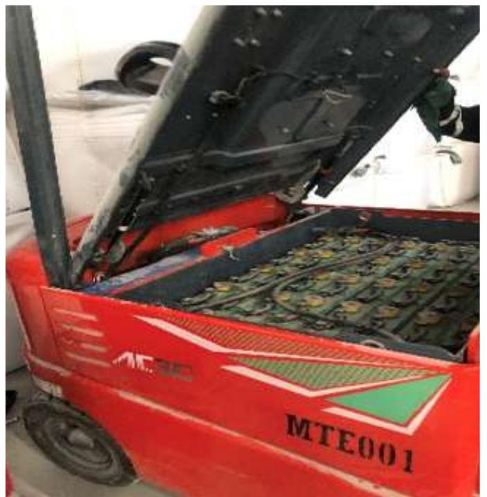
Figura 42. Revisión de baterías y motor eléctrico de la mte-001
