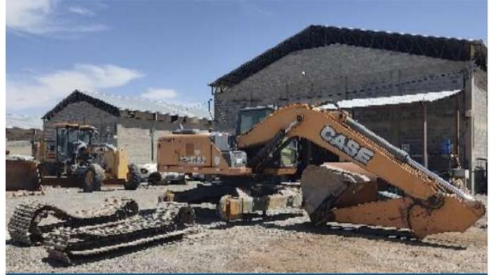
Figura 40. Reparación de rodillos de la exc-001
