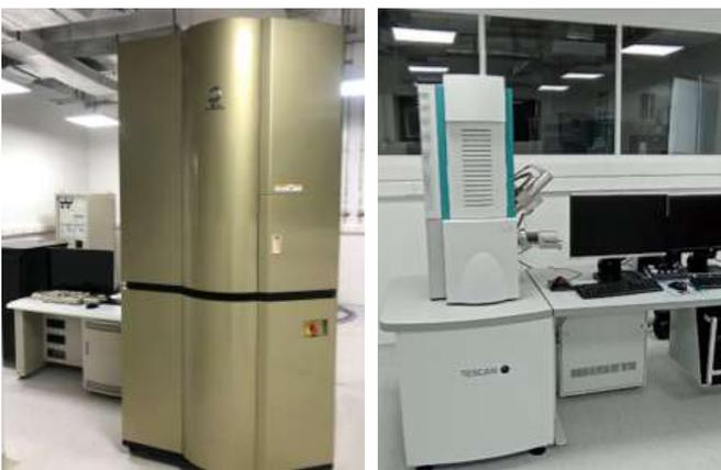
*(Izquierda) Microscopio electrónico de transmisión de alta resolución (TEM-HR)
