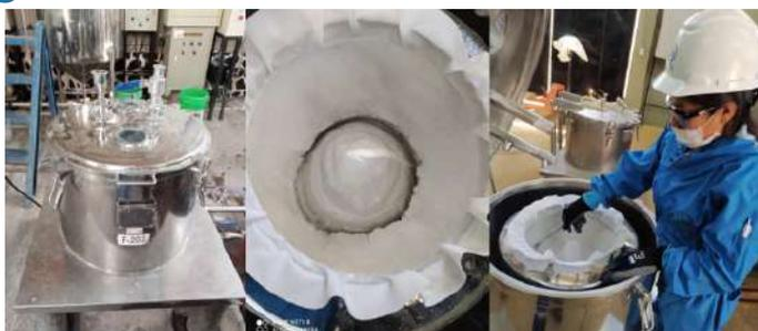
Imagen 6. Etapa de Filtración de  $\text{Li}_2\text{CO}_3$
