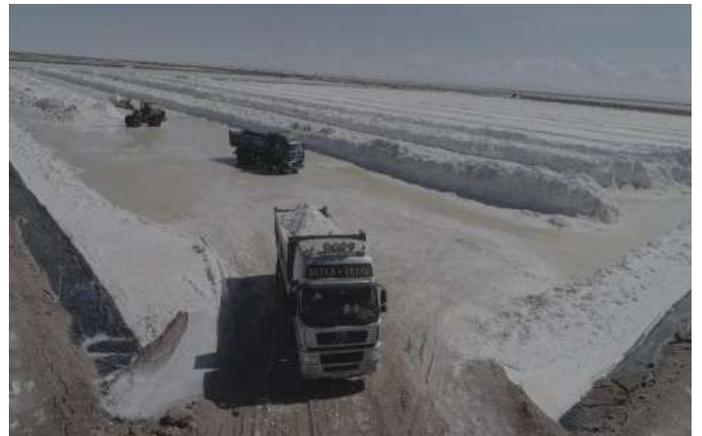
Figura 7. Volquetas saliendo de la Piscina con carga
