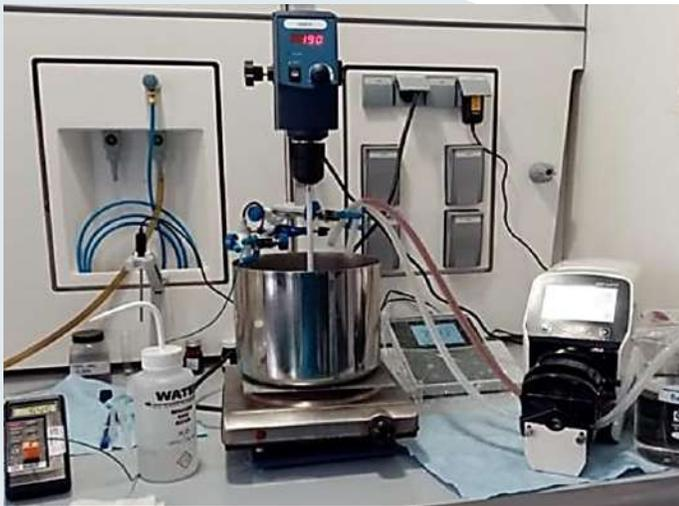
Imagen 14. Montaje de la unidad de coprecipitación a escala laboratorio en la Planta Piloto de Materiales Catódicos
